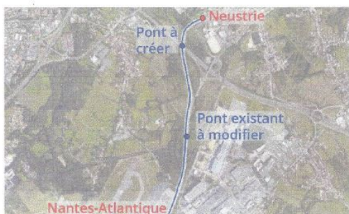
Tracé possible du prolongement de la ligne de tram et aménagements à prévoir.
